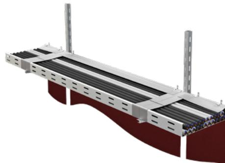
6. Das freie Ende des Brandschutzgewebes um die Kabeltrasse legen und im Abstand von  $\leq 500$  mm (mindestens zwei mal pro Gewebeabschnitt) umlaufend mit Stahlband/-draht befestigen. Die Längsüberlappung muss  $\geq 50$  mm betragen.
